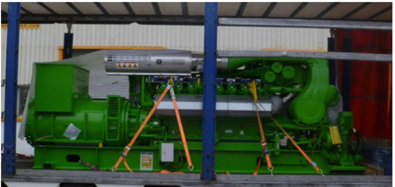
Fig. 14: Posizione dei punti di attacco della serie 4, destra
