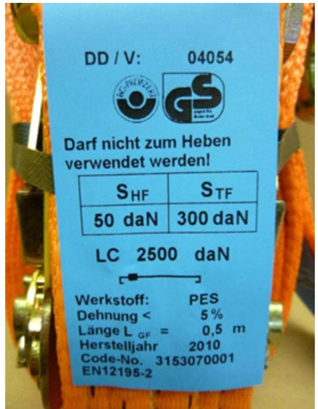
Fig. 3: Etichetta di collaudo del dispositivo di fissaggio secondo EN12195-2
