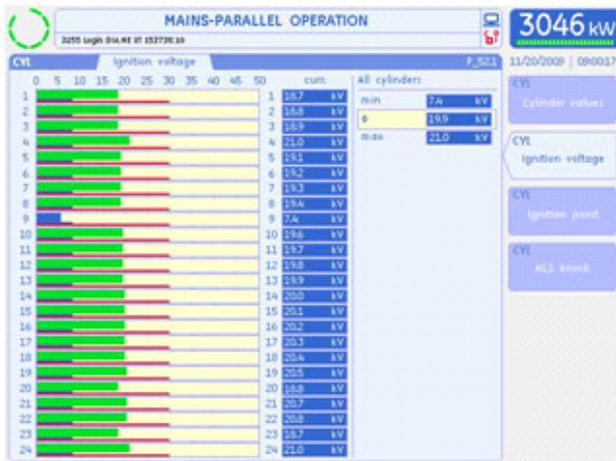
Misurazione dell'alta tensione con MORIS su un DIA.NE XT3
