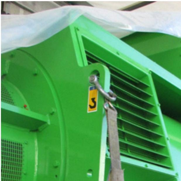
Fig. 24: Dettaglio punto di attacco 1 generatore
