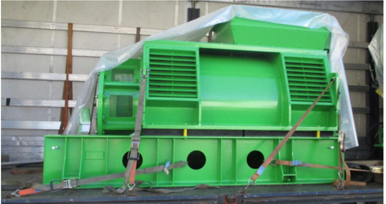
Fig. 23: Posizione dei punti di attacco del generatore, destra
