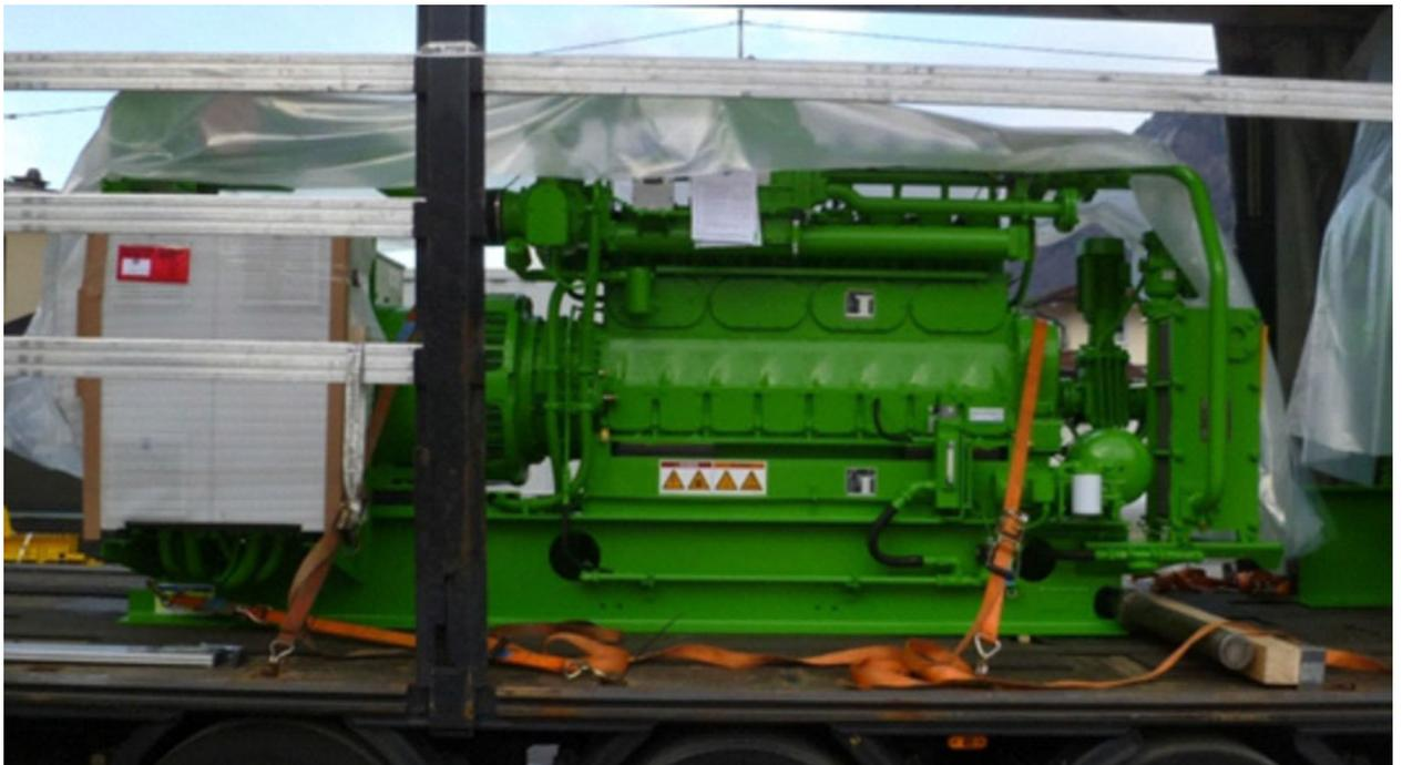
Fig. 8: Posizione dei punti di attacco della serie 2, destra
