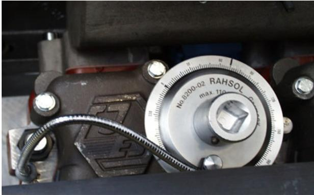
Serrare a mano le viti e quindi serrare a fondo procedendo a croce ad una coppia di 200 Nm (iniziare il serraggio "dall'alto" sul lato aspirazione). Installare il dispositivo per il serraggio con riferimento angolare (vedere figura) e serrare ulteriormente a croce per
