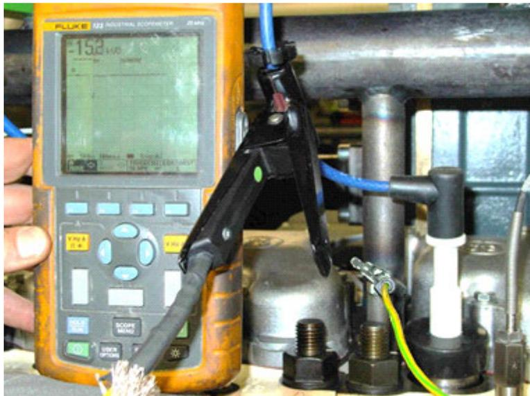
Misurazione alta tensione con pinza per alta tensione e oscilloscopio digitale con memoria FLUKE 123
