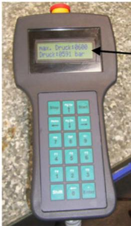
Pressione cilindro di tensionamento
