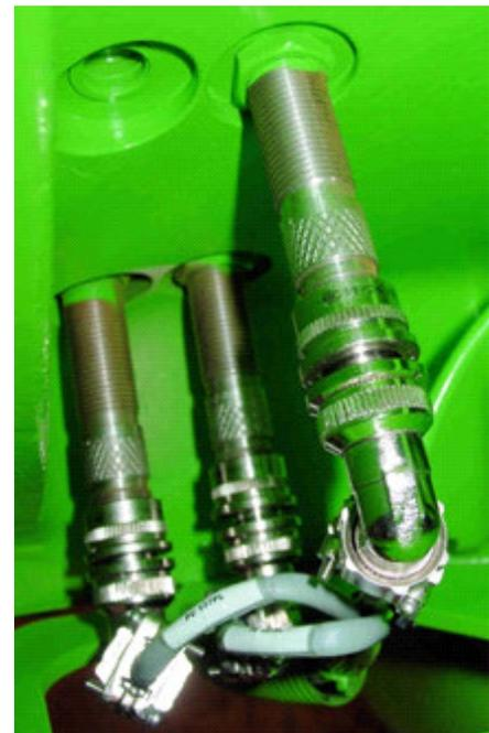
*Fissaggio dei rilevatori di impulsi dell'albero a camme (sinistra) e della corona dentata per l'avviamento (attivazione) / di ripristino (reset) (destra)*
