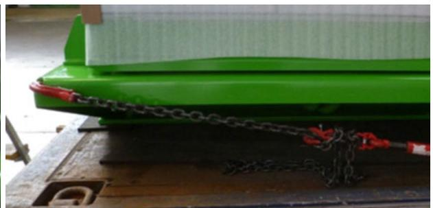
Fig. 22: Dettaglio punto di attacco 4 J624
