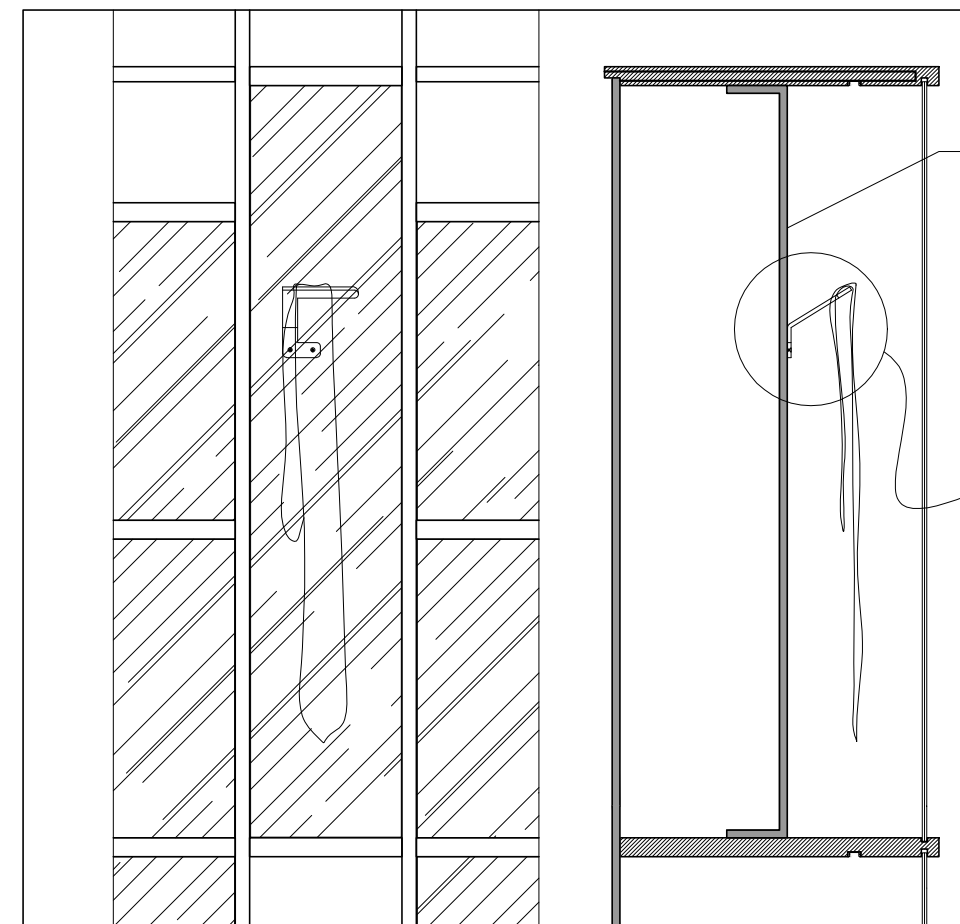
DETTAGLIO APPENDIMENTO CRAVATTA-Scala 1:10
