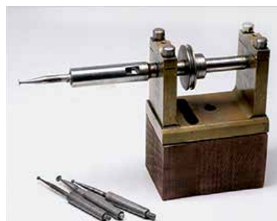
5. Trapano da incisione per punta conica di piombo (1860 circa)
