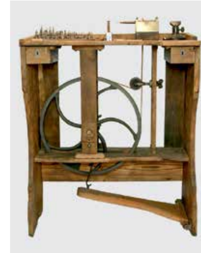
1 Il banco di lavoro di Natter, a piede, funzionava in modo simile a questo modello compatto. Qui il volano è disposto trasversalmente (1860 circa)
